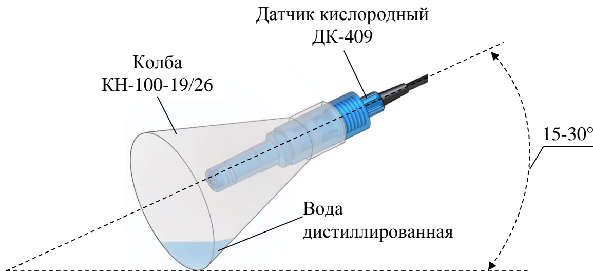
Рисунок 2.8 – Градуировка датчика ДК-409
