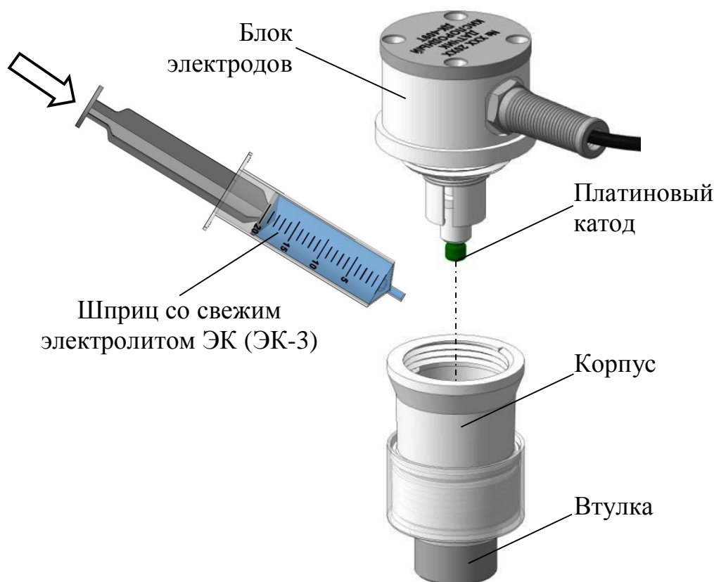
Рисунок 2.7 – Заливка электролита в датчик ДК-409Т, ДК-409ТМ
