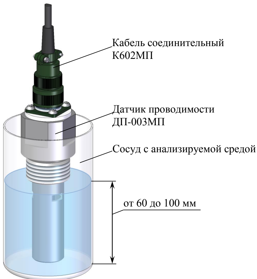
Рисунок 2.8 – Расположение датчика проводимости ДП-003МП в сосуде
